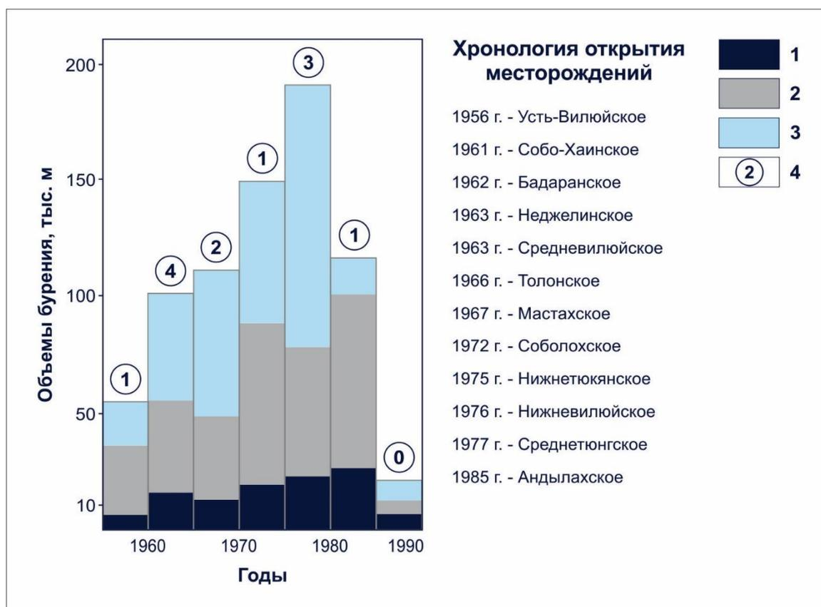
Рисунок 2 – Динамика объемов глубокого бурения и открытия месторождений в Лено-Вилуйском бассейне [Нефтегазоносные..., 1994, с дополнениями и изменениями автора] Условные обозначения: 1 – параметрическое, 2 – поисковое, 3 – разведочное бурение; 4 – количество открытых месторождений.
